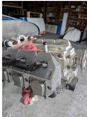
Cooling fins trimmed
